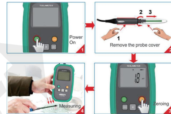
Abb. 3.4 Schematische Darstellung der grundlegenden Messschritte
